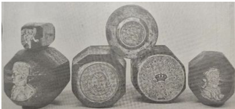
Figura 5: Cuños y troqueles. Puede apreciarse el troquel abierto por Casildo España para la Sociedad. Foto: El grabado guatemalteco.
