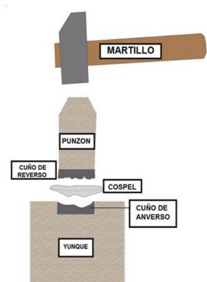
Esquema de una acuñación a Martillo
