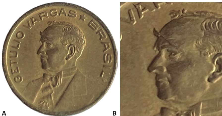
Figura 5: A) Anverso da moeda de 10 centavos de cruzeiro do ano de 1944, batida em bronze-alumínio, com 5 g de peso e 21 mm de diâmetro, na qual se observa o empastamento que a rebatizou de “Getúlio com chifre”. B) Detalhe ampliado do empastamento. Figura 5: A) Anverso de la moneda de 10 centavos de cruzeiro de 1944, batida en aluminio-bronce, con 5 g de peso y 21 mm de diámetro, en el que se puede ver el empastamento que lo rebautizó como “Getúlio con cuerno”. B) Detalle ampliado del empaste.
