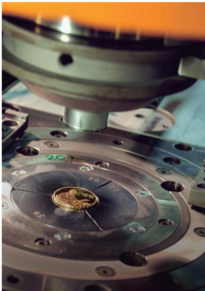
Figura 26. Maquinário da Casa da Moeda de Berna. Exemplo da virola dividida em três partes. Fonte: Swissmint. Maquinaria de la Casa de la Moneda de Berna. Ejemplo de la férula dividida en tres partes. Fuente: Swissmint
