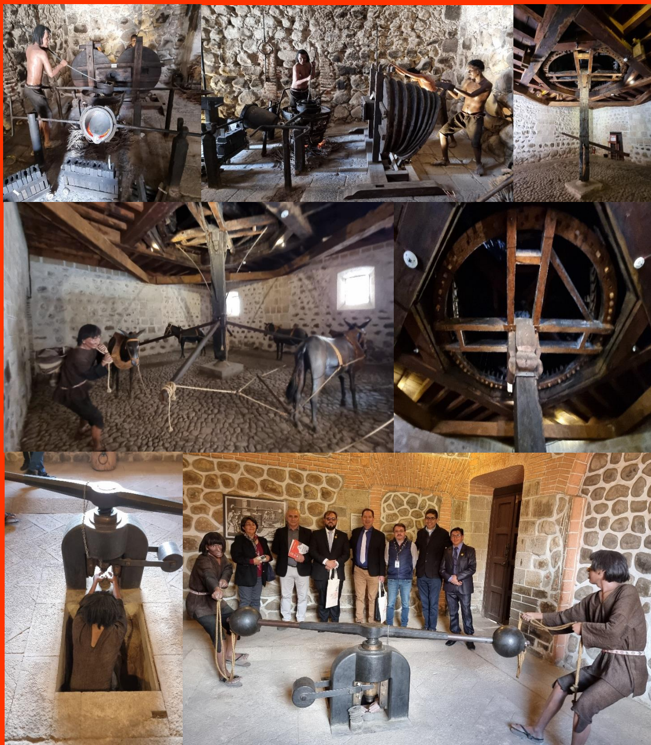
Algunos de los distintos pasos en la fabricación de monedas: fundición, laminación y acuñación.
