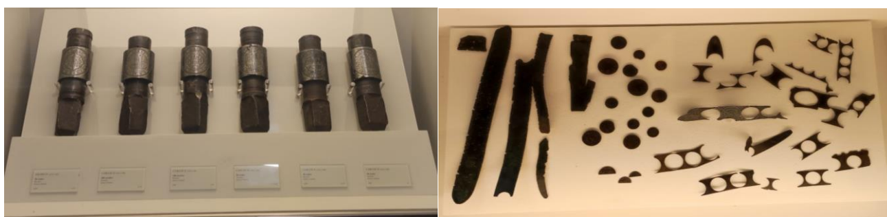
Rodillos utilizados en la acuñación y restos de metales laminados sobrantes después de tratar el acuñado a rodillo con sacabocado. Recuperados en las ruinas de la Ceca.
