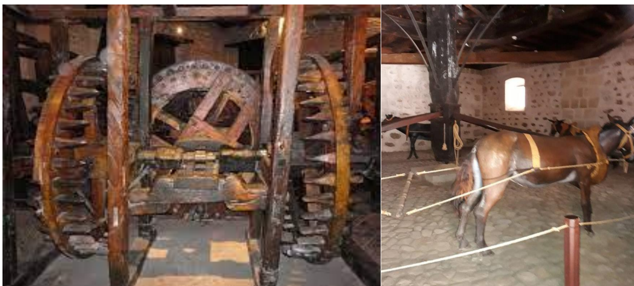
Laminadora potosina movilizada por tracción a sangre. Ubicada en la Casa de Moneda de la Villa Imperial.
