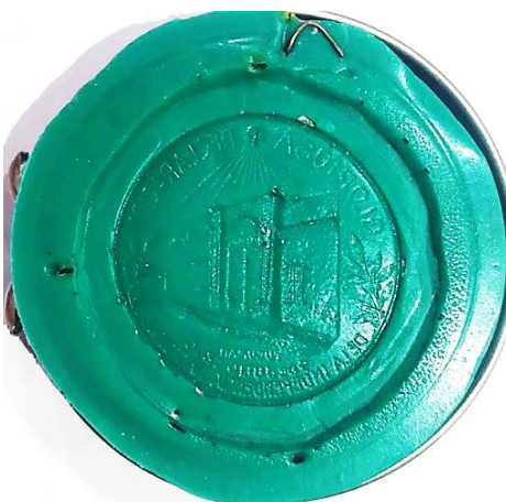
Uno de los pasos en la fabricación de la medalla es elaboración de un molde de silicona (verde).
