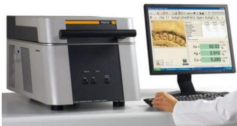
El equipo Fischerscope X-Ray Scan que realizó el análisis por fluorescencia de Rayos X.
