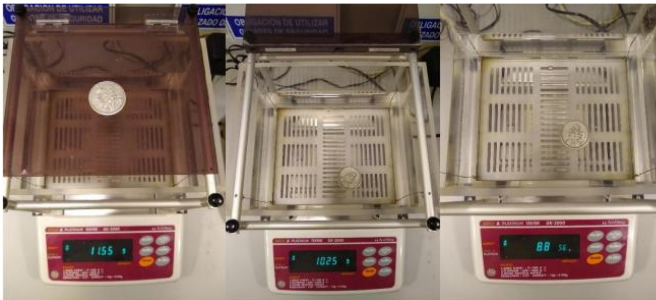
Método de determinación de la densidad con el densímetro GK 2000.
