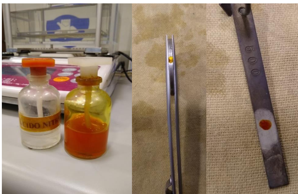
Elementos y realización de la Prueba “al toque”.
