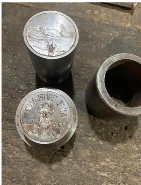
Proceso de armado del cuño con su correspondiente cintura o anillo y el empujador.
