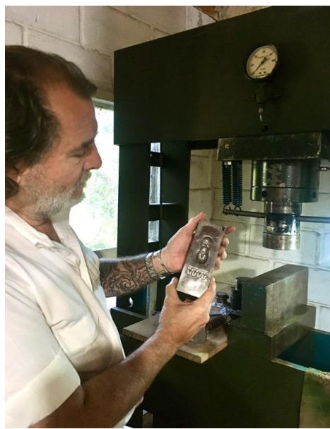
La prensa a utilizar es de 150 Toneladas de empuje. El orfebre con una pieza de prueba.
