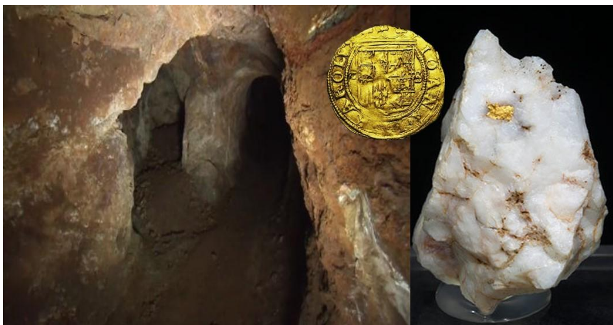
Galería excavada en la roca dura siguiendo la veta de oro.
