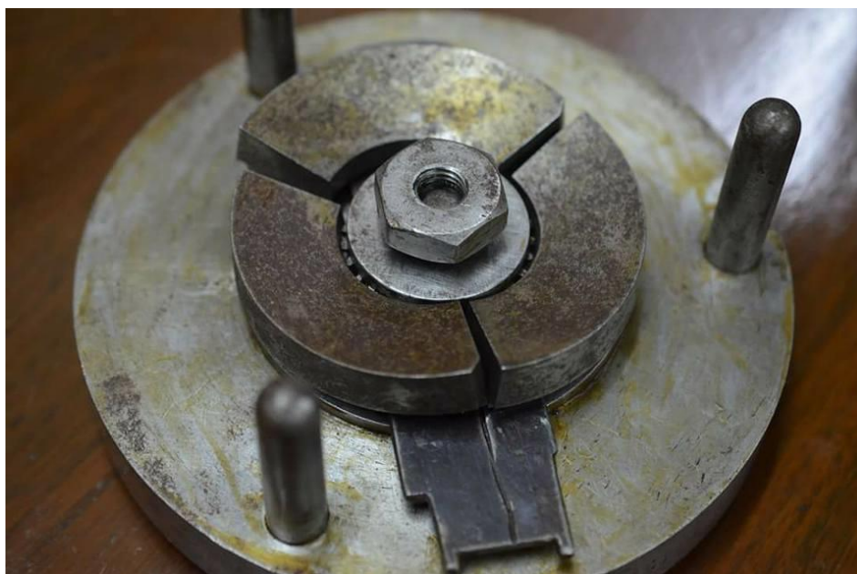
Matriz utilizada para la elaboración del canto parlante de la moneda. IMÁGENES PROPORCIONADAS POR LOS COLEGAS ARGENTINOS EN SU MOMENTO
