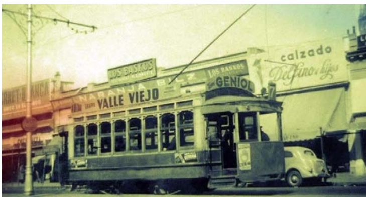
Un coche de "La Inglesa" remozado: mejoras de ventanillas, colocación de faro delantero pero mantiene la misma publicidad.
