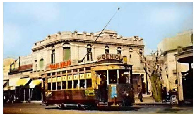
Un coche de "La Inglesa" remozado: mejoras de ventanillas, colocación de faro delantero pero mantiene la misma publicidad.
