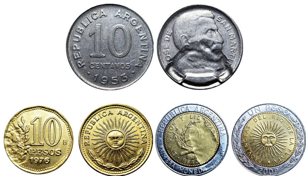
Distintas intrusiones durante el proceso de acuñación. En la mayoría de los casos es muy difícil identificar con que objeto fue el que se interpuso
