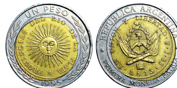
Perforación e inserción descentrada del núcleo. El núcleo conserva su forma redonda pero está incorrectamente ubicado
