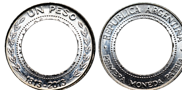
Anillo acuñado sin núcleo. El desplazamiento del metal es hacia adentro ya que hacia afuera esta contenido por el collar
