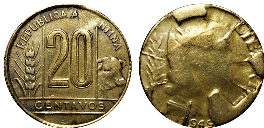
Rotura masiva de cuño martillo. Probablemente esta sea la última pieza obtenida de dicho troquel
