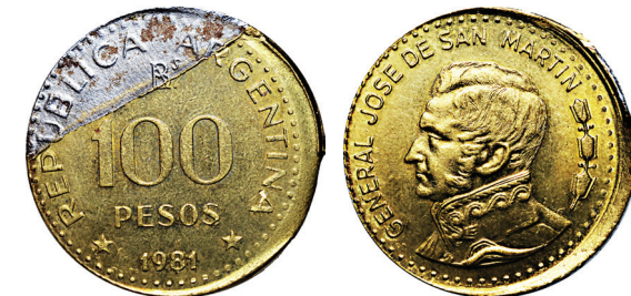
Falla de enchapado y descentrado
