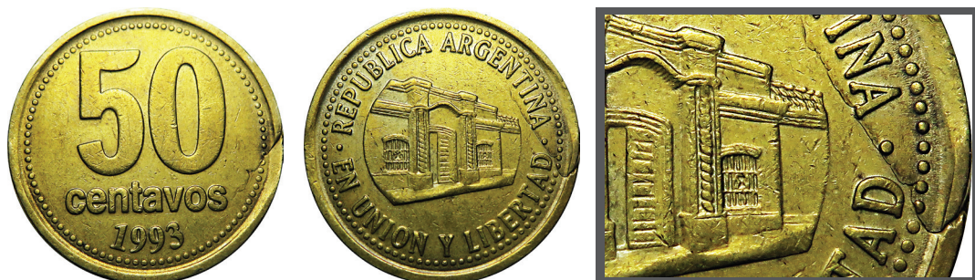
Problema de laminación similar a una quebradura de cospel visible de ambas caras
