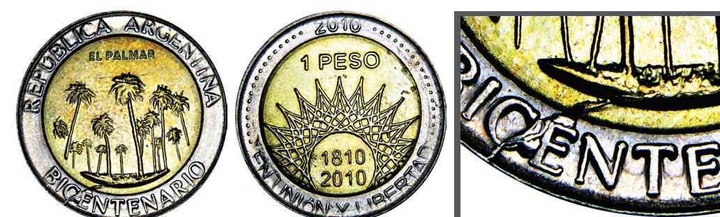
Las roturas de esta extensión en monedas modernas son sumamente raras por tener las prensas actualmente sensores que detienen la acuñación ante el más mínimo desperfecto en los cuños
