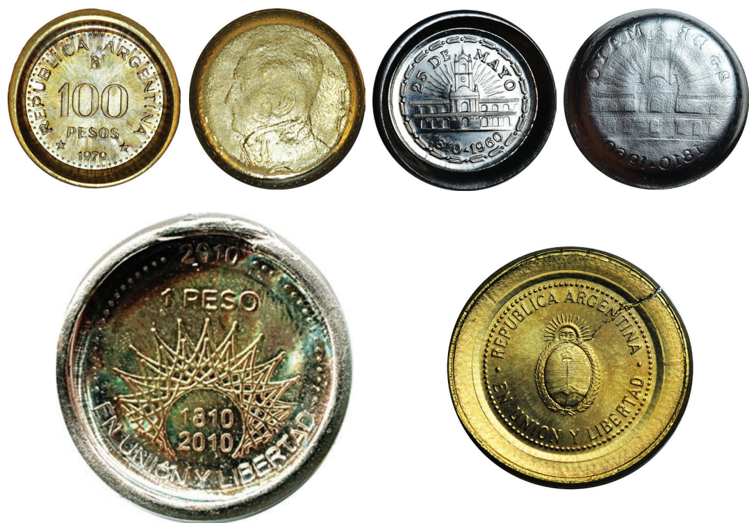
Cuatro casos de tapa de cuño. Estas piezas son difíciles de poner en una carpeta de colección dada su tridimensionalidad
