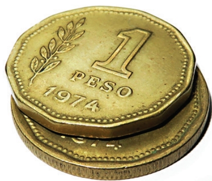
Collar erróneo. Canto duo-decagonal donde debió ser estriado
