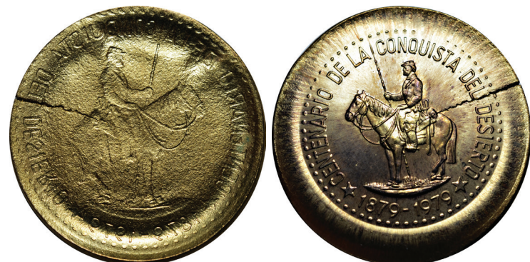
Esta pieza presenta además del diseño incuso, una notable expansión producto de la ausencia de collar y probablemente de varios golpes consecutivos. Es posible que en el cuño opuesto se haya formado una tapa de cuño
