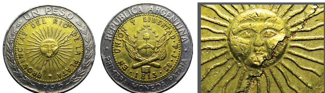
Laminación de núcleo en moneda bimetálica
