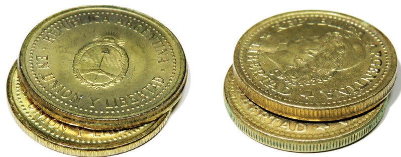
Cantos coronados por collar con altura incorrecta
