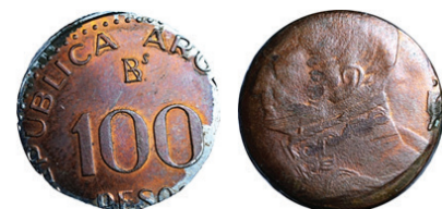
Extraño caso de diseño incuso parcial, por una pieza acuñada de menor diámetro. Posiblemente el cospel equivocado quedó atrapado y se volvió a acuñar sobre un cospel correcto
