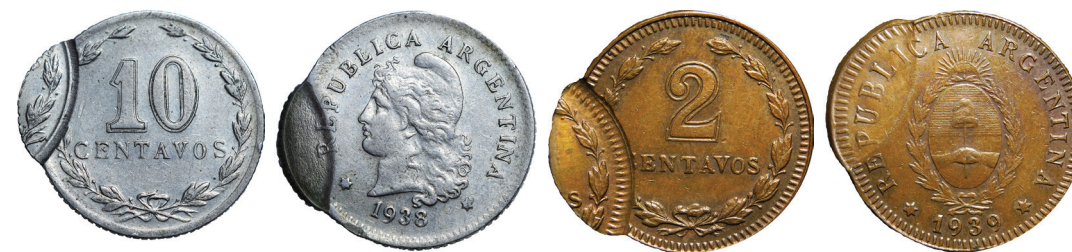
Los golpes múltiples pueden ser en ambas caras o tan solo en una, dependiendo de las incidencias al momento del error, en algunos casos, un segundo cospel puede interferir y generar asimetrías
