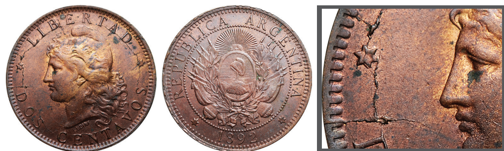
Rotura de cuño que rodea toda la circunferencia del texto del anverso en forma de tela de araña
