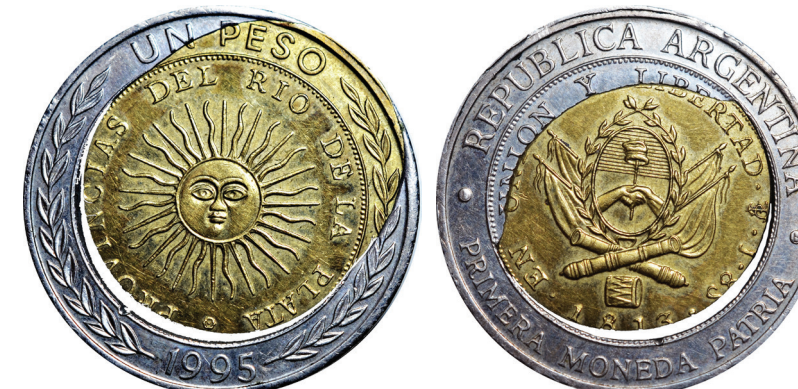
Inserción descentrada del núcleo. La "ventana" es característica de este error
