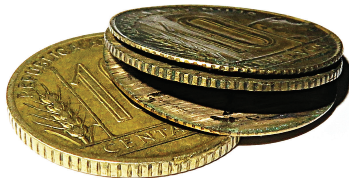
Cospel de 10 centavos de 1947 deslaminado en 3 partes
