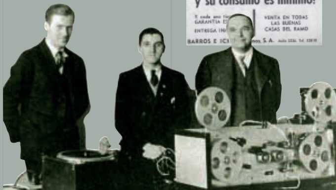
□ Magnetófono de AEG+I. G. Farben para emisora de radio que utiliza una cinta plástica con revestimiento de óxido de hierro magnetizable
